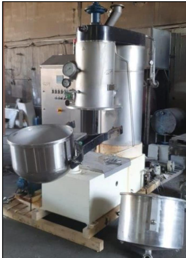
Ilustración: cocedor alta presión para caramelo blando.
