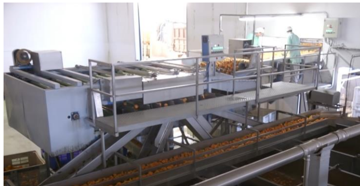
Imagen N° 4.2: Foto cinta transportadora (desde Almacenamiento)
