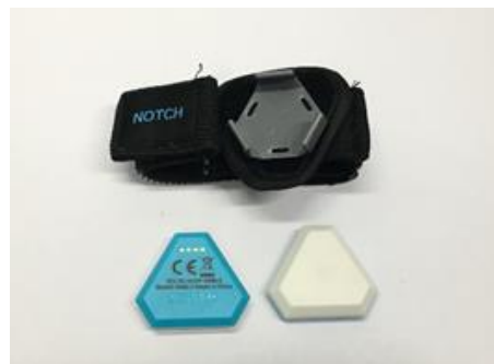
Figura 2. Acelerómetros utilizados en la evaluación, pesan alrededor de 10 gramos y miden 2 centímetros de diámetro aproximadamente. Son instrumentos livianos y pequeños que no afectan en ninguna medida la integridad de los participantes.
